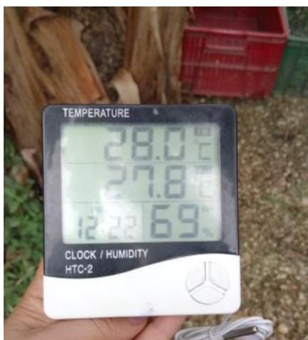
**FIGURA 6.3 EQUIPO DE MEDICIÓN TERMO HIGRÓMETRO**
