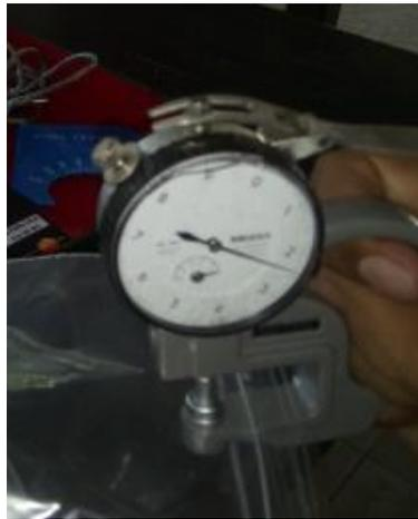
**FIGURA 6.4 EQUIPO DE MEDICIÓN DE ESPESORES**
